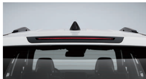
Sportowy tylny spojler z wbudowanym światłem stop w technologii LED
