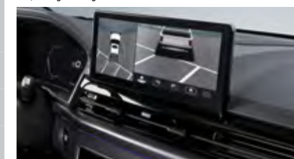
System kamer 360 stopni
